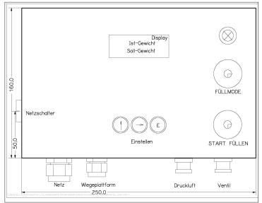
Unten befinden sich die Durchführungen für die o.a. Kabel und Schläuche.
